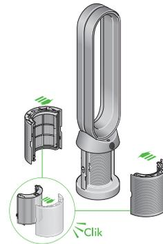
Filterabdeckungen des Luftreinigers sind geöffnet, sodass ein HEPA-Filter und ein Aktivkohlefilter zu sehen sind. Pfeile zeigen an, dass die Filterabdeckungen am Sockel des Geräts montiert werden müssen.
