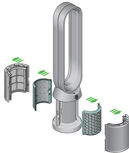
Filterabdeckungen des Luftreinigers sind geöffnet, sodass ein HEPA-Filter und ein Aktivkohlefilter zu sehen sind. Pfeile zeigen an, dass der Aktivkohlefilter direkt am Sockel des Geräts angebracht wird und die Filterabdeckungen am Sockel des Geräts montiert werden müssen.
