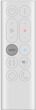
遙控器平面圖，顯示自動模式按鈕位於左邊的氣流速度按鈕下方。
