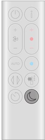
遙控器平面圖，顯示夜間模式按鈕位於右邊最下方。
