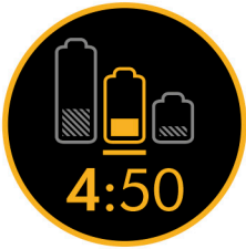
屏幕顯示數字及半滿電池圖標，代表剩餘的電池操作時間。
