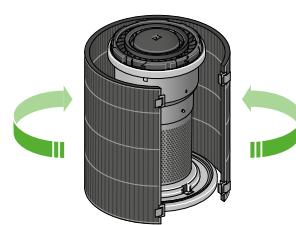
Pengguna sebaiknya menarik keempat klip tersebut ke arah mereka untuk melepaskan filter dari bodi penjernih udara. Panah hijau menunjukkan arah untuk melepas filter dari penjernih udara.
