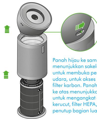
Panah hijau ke samping menunjukkan saklar pelepas untuk membuka penjernih udara, untuk akses mengganti filter karbon. Panah hijau ke atas menunjukkan arah untuk mengangkat amplifier kerucut, filter HEPA, dan penutup bagian luar.
