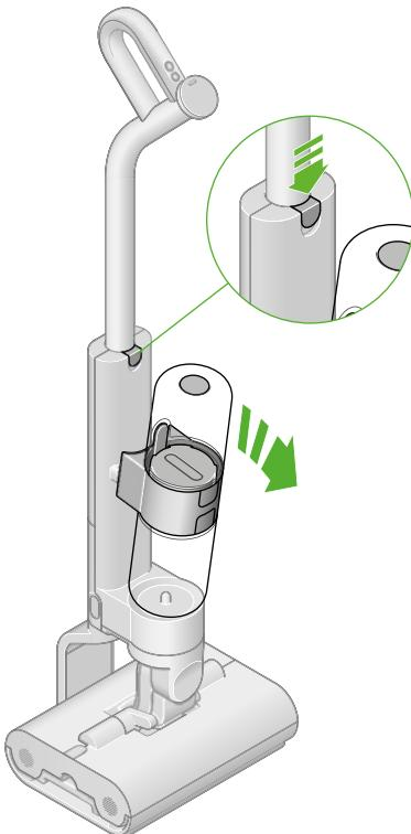
Diagram yang memperlihatkan cara menekan tombol pelepas untuk melepas unit tangki dari mesin.
