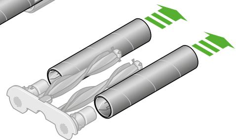
Dua diagram berurutan dengan panah hijau memperlihatkan cara melepas unit rol.
