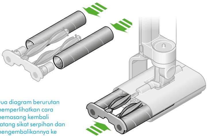
Dua diagram berurutan memperlihatkan cara memasang kembali batang sikat serpihan dan mengembalikannya ke unit rol dan mesin.
