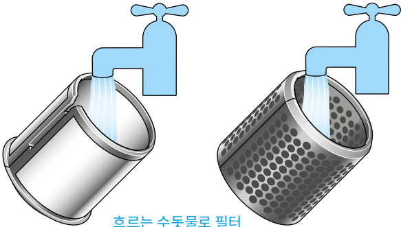
흐르는 수돗물로 필터 케이지와 내부 필터를 세척하는 모습.
